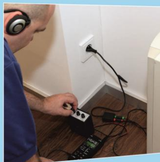
Linkový adapter LTA-3 napojený na detektor v pole RFD-5 slouží k odhalení odposlechu pracujícího v nízkofrekvenčním spektru a pracujících v pásmu 20kHz-41MHz
